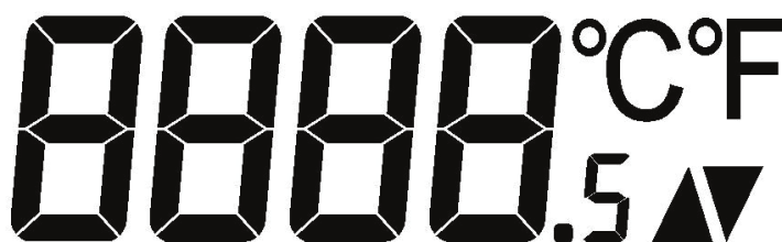
Representação do visor: leitura, unidade e indicação de máximo/mínimo.
